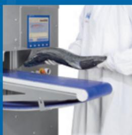
Una bilancia in linea (opzionale) permette di ottimizzare la precisione al variare delle caratteristiche dei prodotti.
